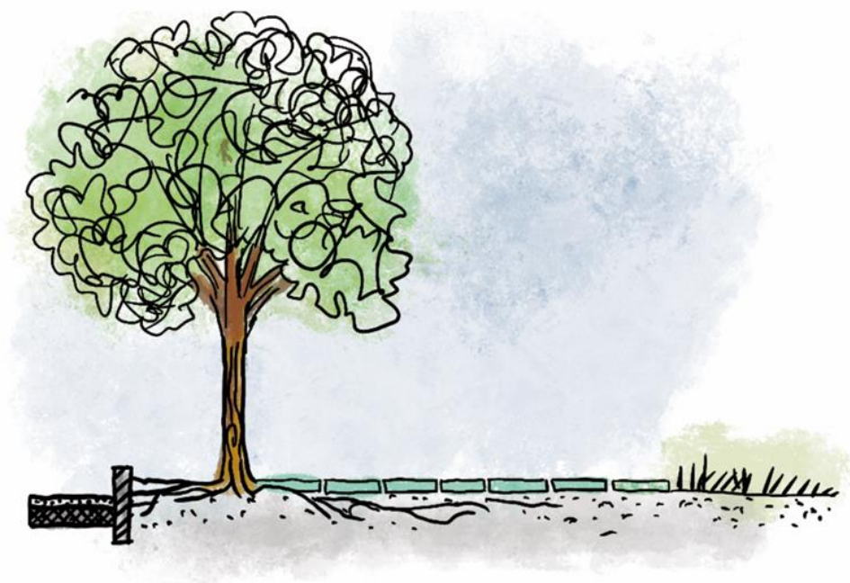
Ilustracja 45. Rozmieszczenie korzeni pod jezdnią, chodnikiem i w pasie zieleni
