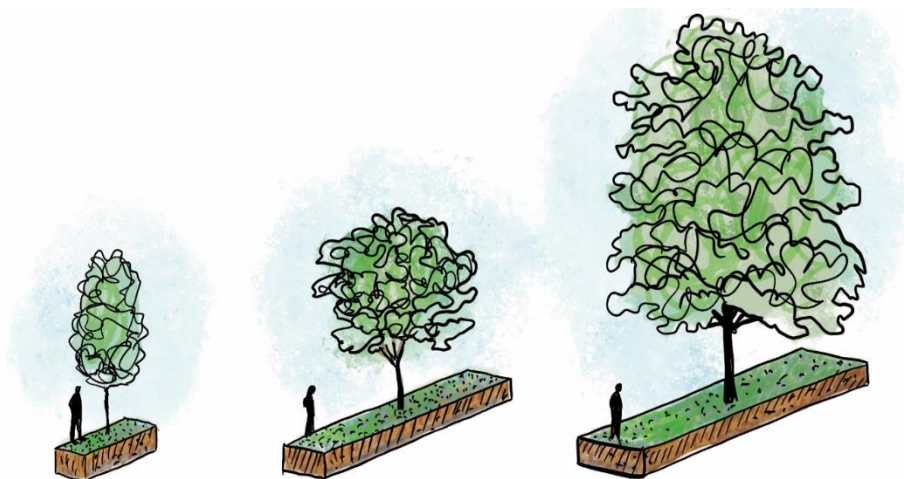
Ilustracja 47. Wymagania dotyczące wielkości mis w zależności od docelowej wielkości drzewa (drzewa małe, średnie, duże)
