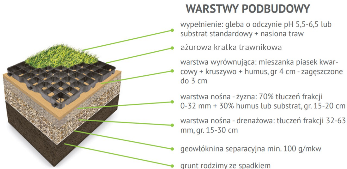
Uszczegółowienie warstw podbudowy – schemat
